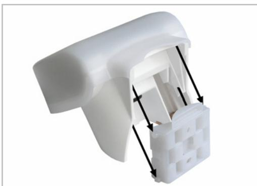
Schieben Sie das Gehäuse von oben in den montierten Halter. Die Zapfen des Halters müssen dabei in den Schienen des Gehäuses einrasten.
