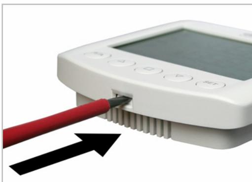
Öffnen Sie das Bedienteil, indem Sie die Verriegelung am unteren Gehäuserand lösen. Hierzu drücken Sie mit einem Schraubendreher gerade in den Spalt.
